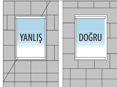
Isı yalıtım levhaları yerleştirilirken duvardaki pencere vb. boşluklar dikkate alınmalıdır. Bu bölümler çatlamaya karşı riskli bölgeler olduğundan, uygulama resim 6'da gösterildiği gibi yapılmalıdır. (Resim 6)
